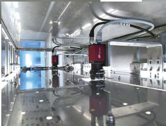
Blick ins Systeminnere mit Kameras und LED-Beleuchtung
