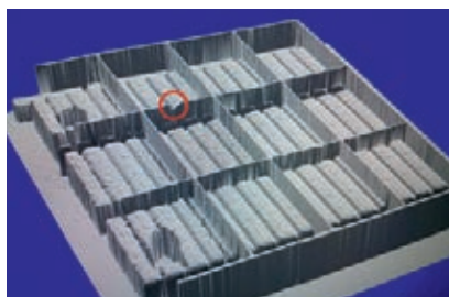
3D-Bild mit markiertem Ausbruch
