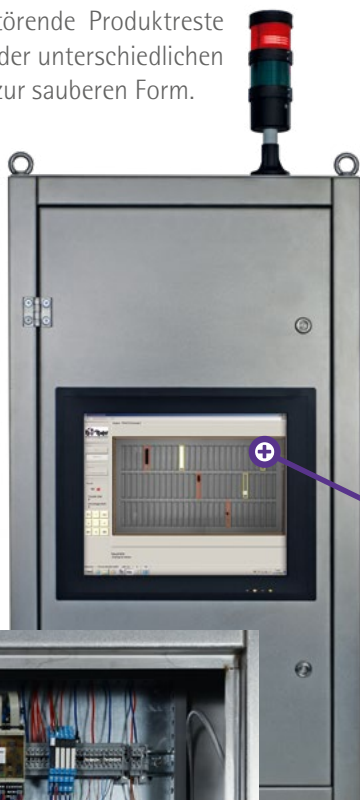
System zur Formenleerkontrolle - Gesamtansicht
