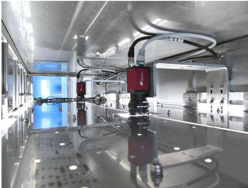
Bild: Spritzwassergeschütztes Inspektionssystem für Leerformen in der Süßwarenproduktion (Revisionsfenster an beiden Seiten für das Foto geöffnet)
