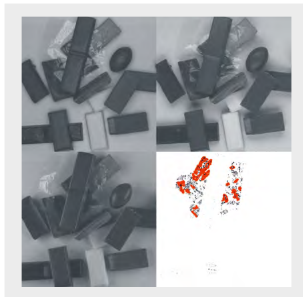
Die Software kombiniert jeweils drei Aufnahmen mit unterschiedlich polarisierter Beleuchtung. Reflektierende Flächen sind deutlich heller und werden durch Binarisierung von der Schokolade und dem Hintergrund abgegrenzt.
