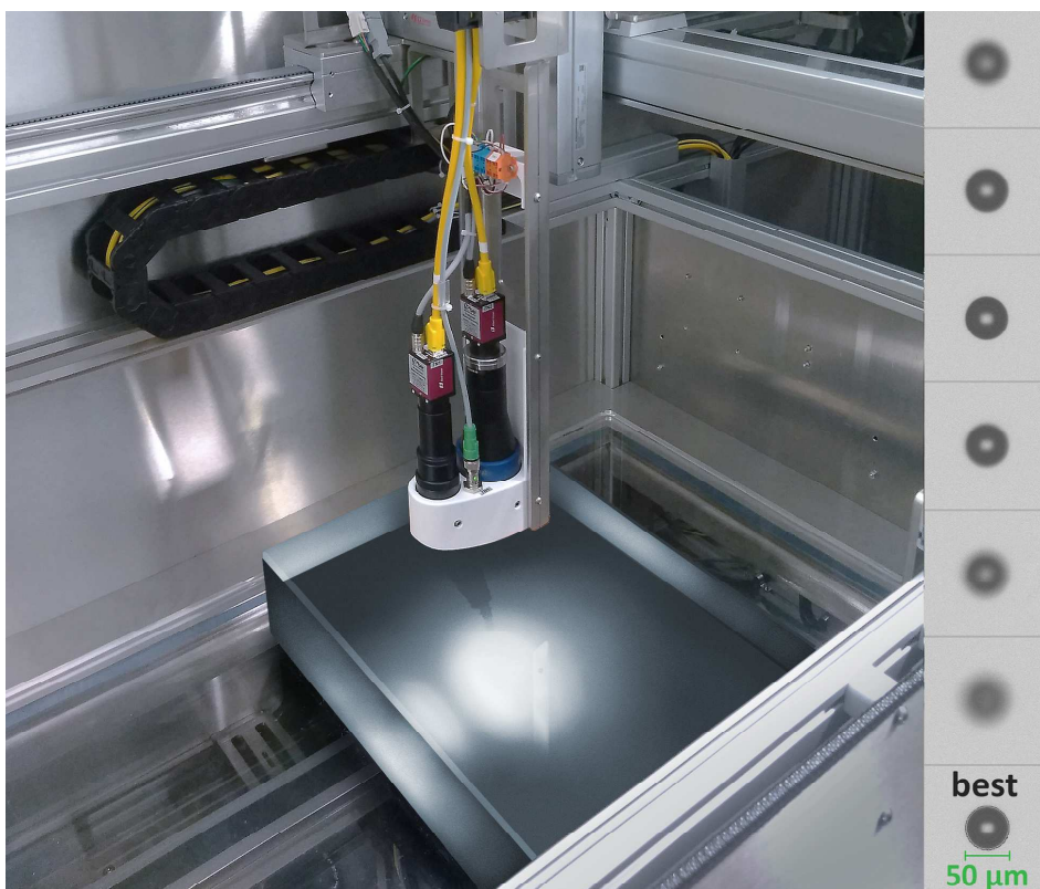
Bild: Durch Schärfenabgleich kann das automatische Messsystem Blasen nicht nur genau vermessen, sondern neben den xy- auch die z-Koordinaten bestimmen
