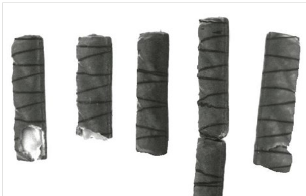
Fehlerarten v.l.n.r.: Loch, Bruch, unregelmäßige Streifenverteilung, verklebte Riegel, Bruch in der Waffel
