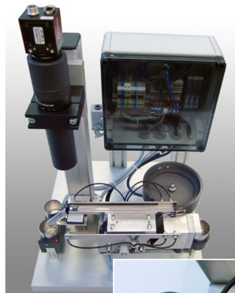
Prüfanlage zur Kontrolle der Distanzstücke
