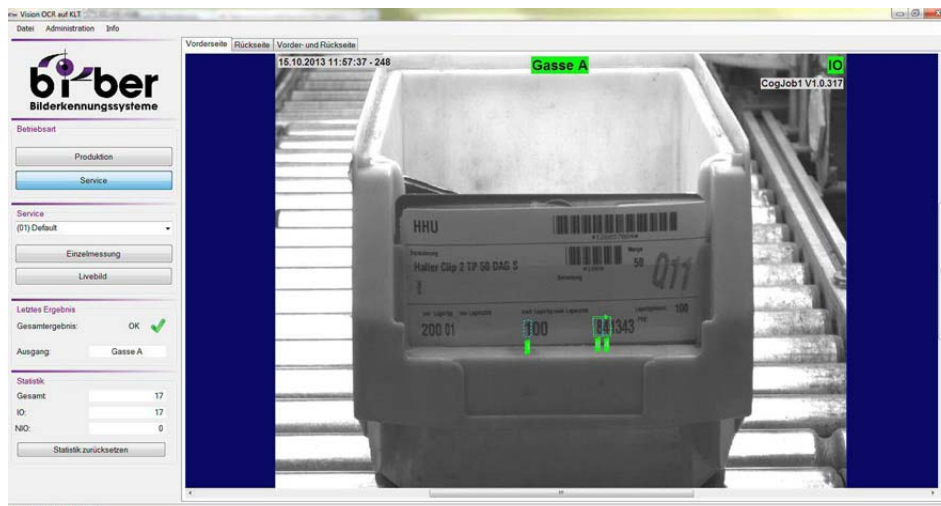
Bild 4: Das Bildverarbeitungssystem liest automatisch die Zahlencodes auf Etiketten von Kleinladungsträgern
