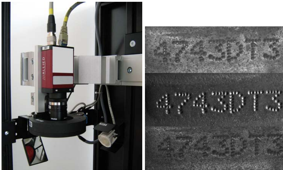
Bilder 1, 2: Arbeitsplatz mit Beleuchtung für die Zeichenerkennung (links), drei Aufnahmen mit verschiedenen Beleuchtungskombinationen (rechts)
